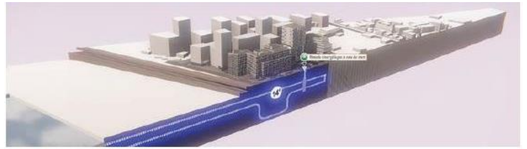
Figure 15 : Les boucles de transfert énergétique, un fondement de la thalassothermie (Source : Plaquette du projet Smartseille, Eiffage)
